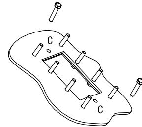
5. Положить уплотнение на винты с наружной стороны крыши силосной конструкции. Вогнутая сторона уплотнения должна быть направлена к поверхности крыши силосной конструкции, рефленная сторона уплотнения должна смотреть наверх.
