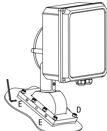
7. Выставить прибор вертикально при помощи строительного уровня. (максимально возможное отклонение 2°). Завинтить два винта "E" с силой 15 Нм.
