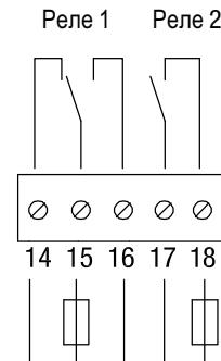
Предохранитель: макс. 2A
