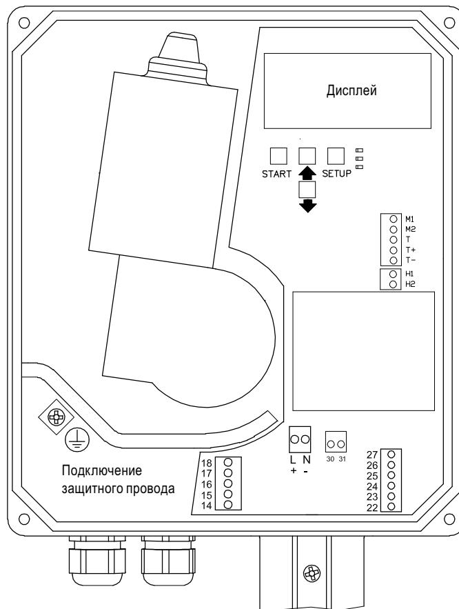
Внутренние клеммы для мотора и отопления
