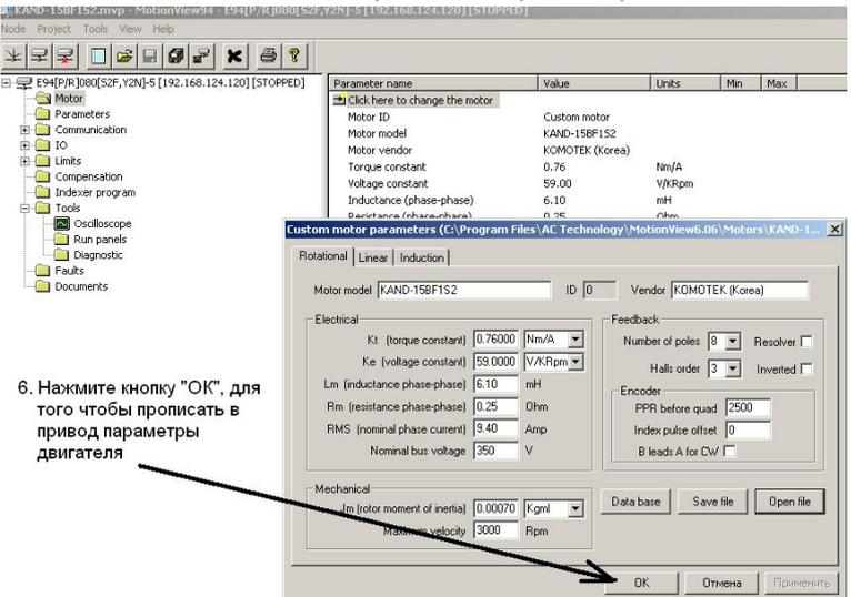
6. Нажмите кнопку "OK", для того чтобы прописать в привод параметры двигателя
