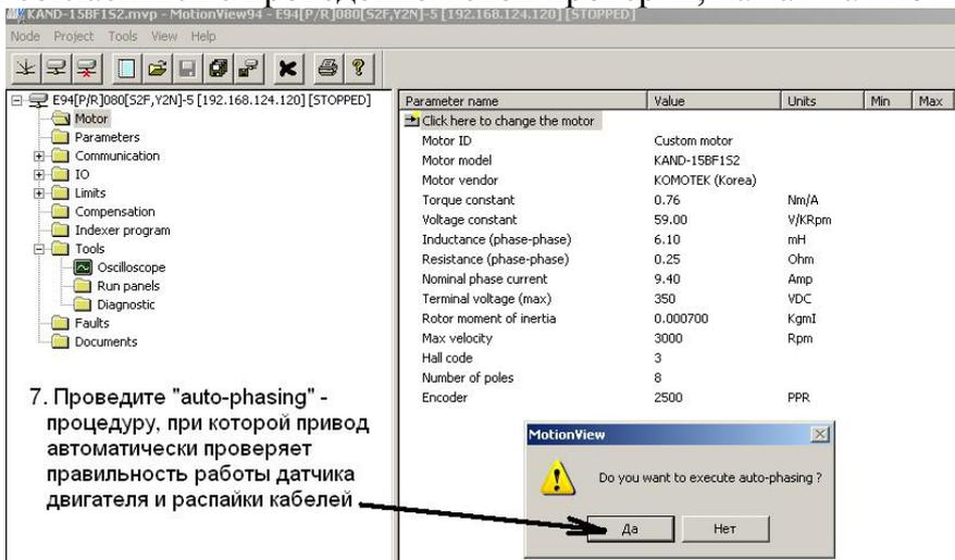
7. Проведите "auto-phasing" - процедуру, при которой привод автоматически проверяет правильность работы датчика двигателя и распайки кабелей
