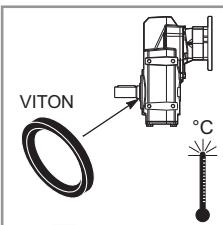
In caso di temperature elevate consigliamo di montare anelli di tenuta in VITON sull'albero uscita.
