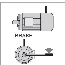
Segnalare se l'utilizzo è con motore autoreverse con elevati numeri di manovra. Nelle installazioni accertarsi che la coppia generata dall'inerzia del carico in fase di frenatura non superi i limiti del riduttore; verificare (con chiave dinamometrica) che la coppia di taratura del freno corrisponda ai dati convalidati dal progetto.
