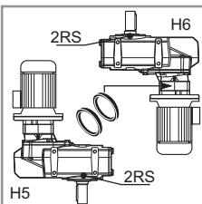
Specificare in fase d'ordine se i riduttori richiesti vengono utilizzati per posizioni di montaggio verticali H5+H6. Per queste posizioni va previsto un cuscinetto schermato 2RS come in figura. Per montaggio H6 suggeriamo l'uso di 2 anelli di tenuta in entrata. H6 (Posizione sconsigliata con motori 2 Poli).
