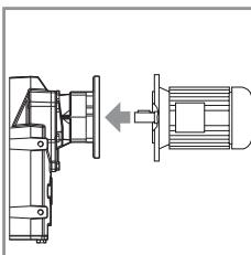
L'accoppiamento al motore deve essere libero e scorrevole. Il serraggio delle viti di fissaggio deve essere effettuato solo quando le due flange saranno a contatto.
