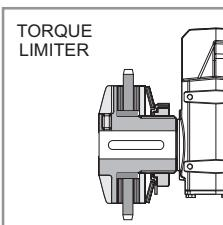
Se nell'applicazione si prevedono sovraccarichi prolungati, urti o bloccaggi improvvisi, installare sistemi meccanici o elettronici di limitazione della coppia.
