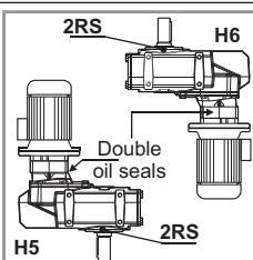
I riduttori sono forniti per posizioni di montaggio standard H1 se non diversamente specificato in fase d'ordine.
