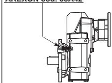
In applicazioni caratterizzate da numerosi avviamenti/arresti o inversioni, è consigliabile bloccare le viti di fissaggio delle flange con Loctite cod. 270 oppure Arexons cod. 35A42.
