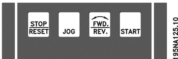
**[STOP/RESET]** (останов/сброс) используется для останова подключенного электродвигателя или для возврата в исходное состояние преобразователя частоты после срабатывания защиты. Активное или неактивное состояние этой кнопки может выбираться с помощью параметра 014 *Местный останов*. При включенном останове будет мигать строка 2 дисплея.
