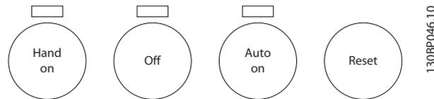
**[Hand On]** позволяет управлять преобразователь частоты с LCP. Кнопка [Hand on] также выполняет пуск двигателя, что делает возможным ввод данных скорости вращения двигателя с помощью кнопок со стрелками. С помощью 0-40 [Hand on] Key on LCP действие кнопки может быть выбрано как «Разрешено» [1] или «Запрещено» [0]
