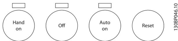
**[Hand on]** позволяет управлять преобразователь частоты с LCP. Кнопка **[Hand on]** также обеспечивает пуск двигателя, после чего с помощью навигационных кнопок можно вводить значения скорости вращения двигателя. С помощью *0-40 [Hand on] Key on LCP* можно выбрать следующие варианты действия кнопки: Разрешено [1] или Запрещено [0].
