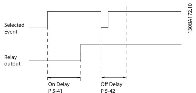
Если состояние выбранного события изменяется до истечения задержки включения или выключения, то это не влияет на состояние выхода реле.
