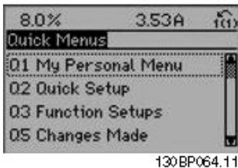
Чтобы использовать ограниченное количество параметров при настройке оптимального режима работы двигателя, выберите *Быстр. настройку*. Установка по умолчанию остальных параметров учитывает нужные функции управления и конфигурацию сигнальных входов/выходов (клемм управления).
