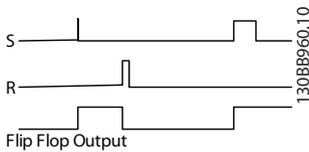
Два оператора могут быть выбраны из длинного списка. В качестве исключения, может использоваться один и тот же цифровой вход для команд Задание и Сброс, что позволяет использовать один и тот же вход для запуска/останова. Приведенные ниже настройки могут использоваться для задания одного и того же входа для запуска/останова (пример приведен для цифрового входа 32, но это не обязательно).
