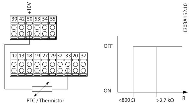
Использование аналогового входа и напряжения 10 В в качестве источника питания:
