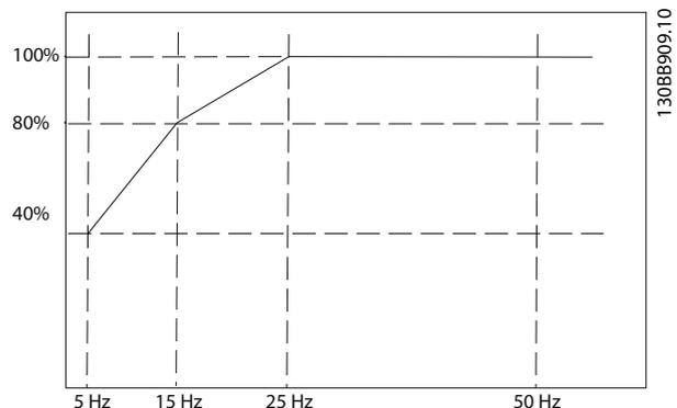
Рисунок 3.7 Пример кривой теплового ограничения ATEX ЭТР.
