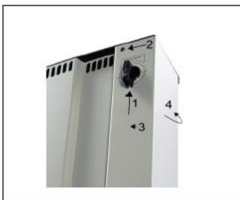
Рисунок 2.6: Техника открывания инвертора
