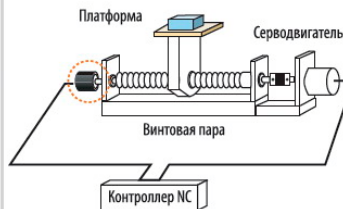
Позиционирование координатного стола в обрабатывающем центре Инкрементальный энкодер
